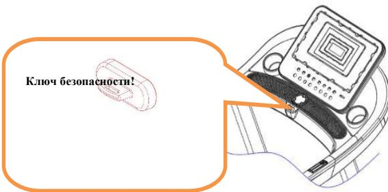
Функция аварийной остановки: после извлечения ключа безопасности из гнезда прекращается подача электропитания и движение полотна прекращается.
