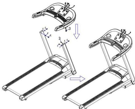
Шаг 4: соедините провода с номерами 2, 3, 4, 5 и 5 в основании консоли с аналогичными проводами в консоли, а затем прикрепите консоль на основании консоли с помощью болтов D#M6\*15 (4).
