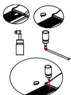
Чтобы смазать беговое полотно следуйте данной инструкции. Откройте находящуюся спереди слева декоративную крышку заправочного отверстия, разрежьте ножом или ножницами верхний край бутылочки со смазкой. Вставьте бутылочку в заправочную трубочку и нажмите. При этом соблюдайте меры предосторожности!
