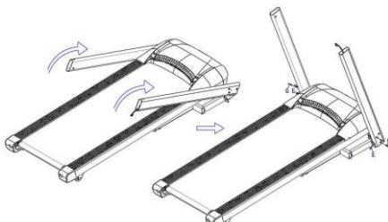
Шаг 3: вначале соедините три провода консоли с тремя проводами в боковых стойках, вставьте основание консоли в боковые стойки как показано стрелкой на рисунке, затем с помощью шайб F #M8 (4) и болтов E #M8\*15 (4) прикрепите основание консоли к боковым стойкам.
