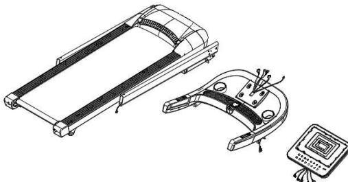
Шаг 2: поднимите боковые стойки в направлении, указанном стрелками на рисунке. С помощью болтов с полукруглой шестигранной головкой M8\*45 (4 шт) и M8\*15 (2 шт) закрепите стойки на главной раме.
