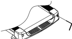
А. Регулировка натяжения бегового полотна. Если беговое полотно послаблено, вставьте шестигранный ключ, входящий в комплект, в левое регулировочное отверстие в задней части дорожки и поверните регулировочный болт на  $\frac{1}{4}$  оборота по часовой стрелке. Затем повторите эту же операцию справа. Если беговое полотно перетянуто, то поочередно поверните регулировочные болты справа и слева на  $\frac{1}{4}$  оборота против часовой стрелки.
