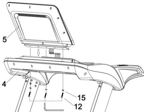
1. Как показано на рисунке, соедините протянутый кабеля дисплея с кабелем от консоли.
