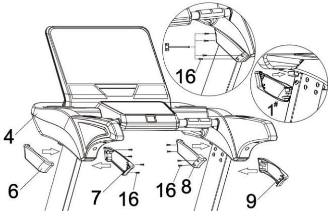
Как показано на рисунке, установите вертикальную крышку используя отвертку и 4-ре винта M4x15 для каждой вертикальной стойки.
