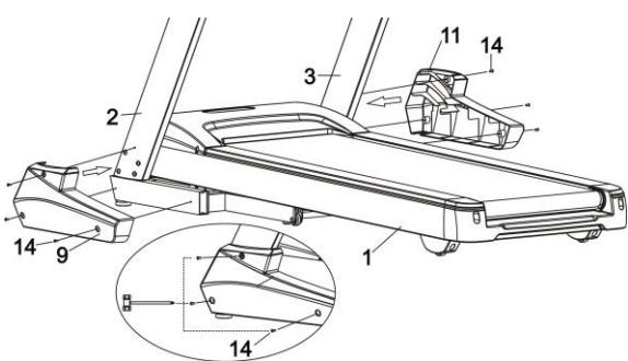
Как показано на рисунке, установите 2 крышки основания на само основание используя отвертку и 3 винта M5x15 для каждой крышки.
