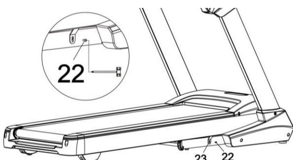
Как показано на рисунке, снимите блокирующий крюк с основания с помощью отвертки.
